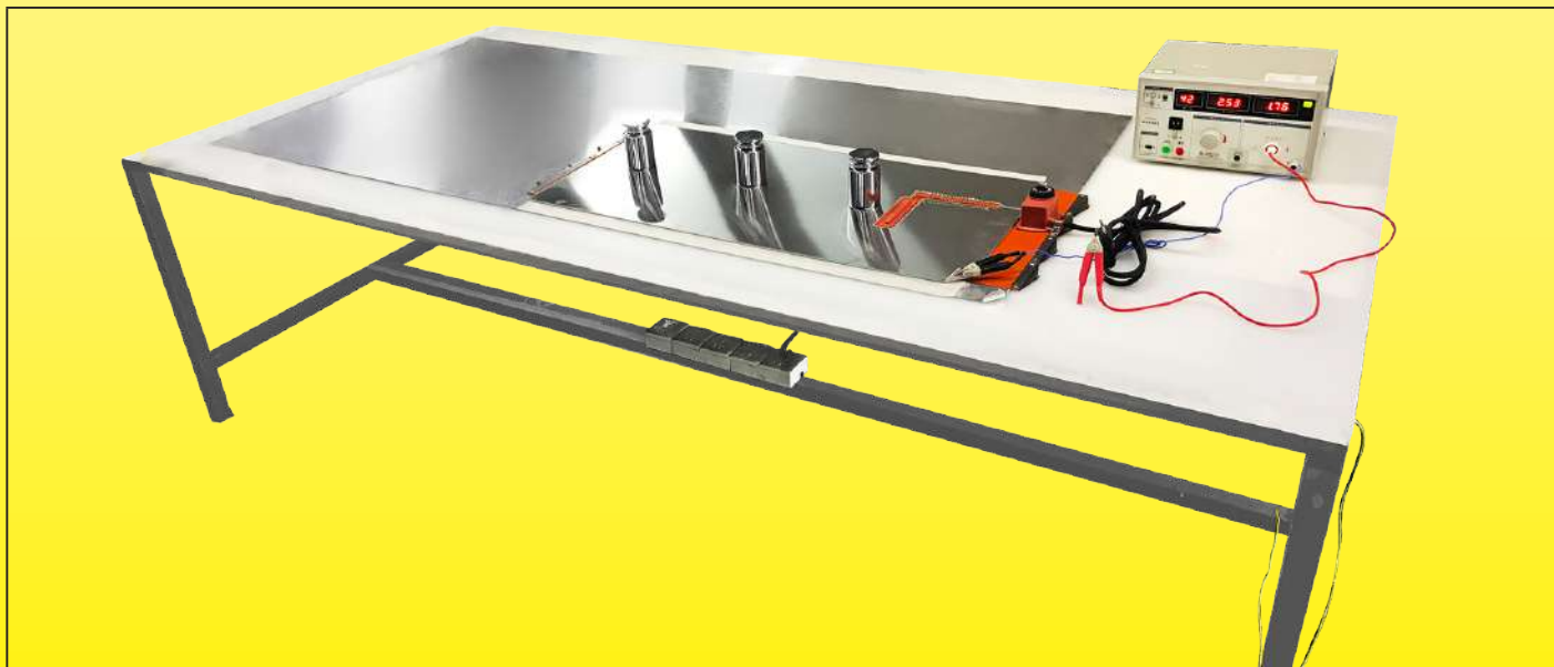
Messgeräte für den Gesamtleckstrom im kalten Zustand
